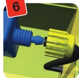
Ora è possibile collegare l'AQUAvalve al tubo da 6 mm. Svitare il collare giallo e spingere il tubo attraverso il collare. Spingere il tubo da 6 mm sull'ugello dell'AQUAvalve e poi rimontare il collare giallo avvitandolo sull'AQUAvalve.
