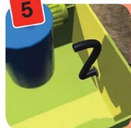
Prendere il tratto di 2 metri di tubo da 6 mm e spingerlo (dall'esterno) attraverso la boccola a cilindro (top hat) da 6 mm, come illustrato nella figura. Tirare il tubo attraverso la boccola così che si trovi a circa 150 mm all'interno dell'AQUAbox Straight.
